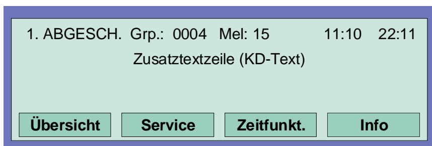
Abb. 26: Displayanzeige zur Abschaltungsmeldung in der Zustandsanzeige
